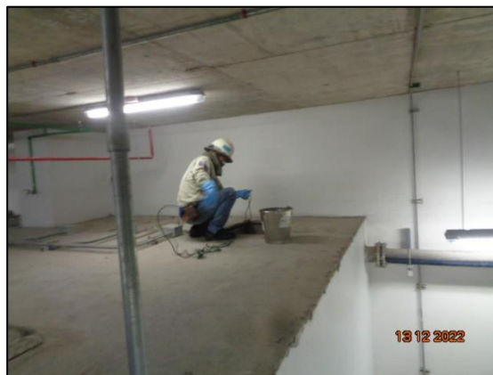
รูปที่ 3.7 การเก็บตัวอย่างคุณภาพน้ำทิ้ง บริเวณบ่อเก็บน้ำใสของระบบบำบัดน้ำเสียรวม
