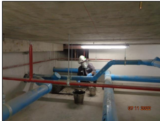
รูปที่ 3.6 การเก็บตัวอย่างคุณภาพน้ำทิ้ง บริเวณบ่อเกรอะของระบบบำบัดน้ำเสียรวม
